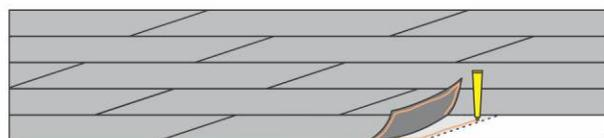
4. Ulangi langkah ke-3 hingga semua bagian tertutup Vinyl Floor. Sisakan 5–8 mm, tergantung suhu maksimal & kelembapan di ruangan tersebut. Gunakan penutup jendela untuk membatasi sinar & panas matahari yang masuk di ruangan & menjaga suhu ruangan tidak terlalu tinggi.
